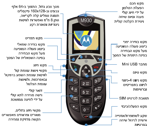
תרשים 1. תרשים בסיסי של הטלפון לרכב מדגם M930.
